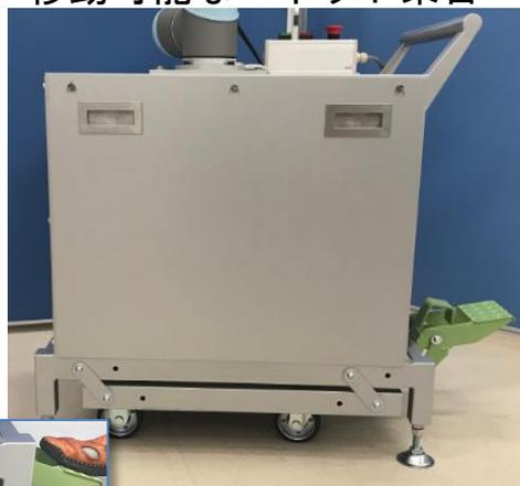
フットペダルでキャスターが上下し、簡単に移動・固定が行えます。
