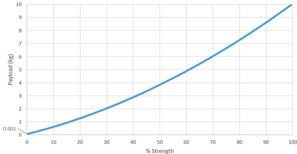
グリッパーの引込力の強度は、グリッパーのフィンガーとワークピースの向き、および材料の種類、厚み、重量、ジオメトリ、表面仕上など、さまざまな特性の影響を受けます。
