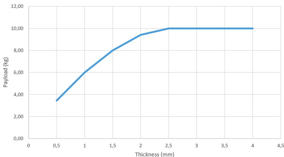
次のグラフは、最大 3G の加速度が使用される場合に、空気ギャップがグリッパーがピックして保持できるワークピースの最大有効荷重にどのように影響するかを示しています。
